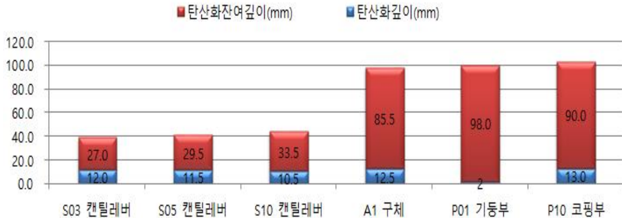
&lt;그림 3.5.7&gt; 탄산화 깊이 측정결과(범물방향)
