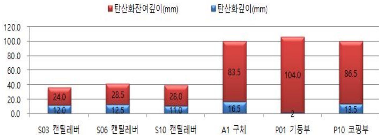
&lt;그림 3.5.8&gt; 탄산화 깊이 측정결과(안심방향)
